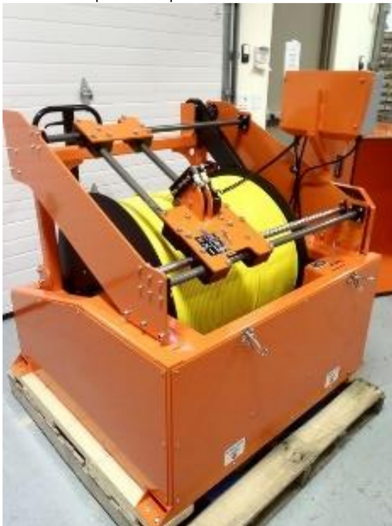
2000 m fiberoptisk kabel på elektrisk winch med meterteller
