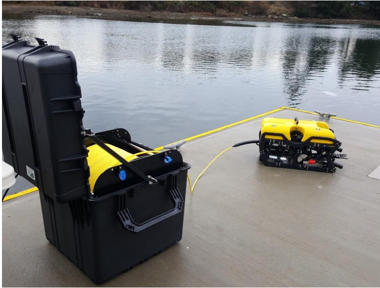
650 m fiberoptisk kabel på manuell kabeltrommel
